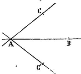
Ainsi la surface plane peut être considérée comme engendrée par le mouvement d'une droite tournant autour d'un point fixe, et glissant le long d'une droite fixe qui ne passe pas par ce point.
