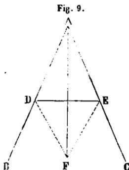
Prenons sur AB un point quelconque D, et retranchons de AC la droite  $AE = AD$  [pr. 3, note]. Joignons DE, et construisons sur DE le triangle équilatéral DEF [pr. 1]. Si l'on joint AF, cette droite partagera l'angle BAC en deux parties égales.
