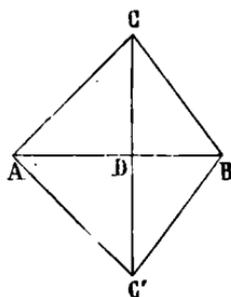
côtés différents de la base commune AB. Chacun des points A, B étant équidistant des points C et C', la ligne AB est perpendiculaire sur le milieu de CC'. Si donc on replie la figure autour de AB, le point C' tombera en C.
