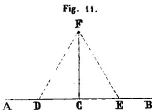
Prenons sur AB un point quelconque D, et faisons  $CE = CD$  [pr. 3, note]. Construisons sur DE le triangle équilatéral DEF [pr. 1], et joignons FC. La droite FC sera perpendiculaire à AB au point C.
