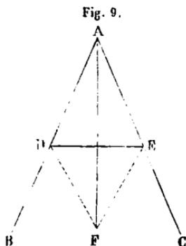
Prenons sur  $AB$  un point quelconque  $D$ , et retranchons de  $AC$  la droite  $AE = AD$  [pr. 3, note]. Joignons  $DE$ , et construisons sur  $DE$  le triangle équilatéral  $DEF$  [pr. 1]. Si l'on joint  $AF$ , cette droite partagera l'angle  $BAC$  en deux parties égales.
