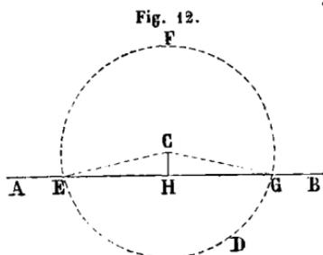
Prenons au-delà de AB par rapport à C, un point quelconque D ; décrivons, du centre C, avec le rayon CD, le cercle EFG ; partageons EG en deux parties égales au point H [pr. 10], et joignons CH : cette ligne CH sera perpendiculaire sur AB.
