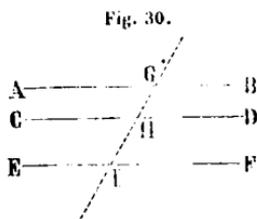
Coupons ces trois droites par la droite GI. Puisque AB et EF sont parallèles, on a  $AGI = GIF$  [pr. 29]. De même, puisque CD et EF sont parallèles, on a  $GIF = GHD$ . Donc  $AGI = GHD$ , et par suite AB et CD sont parallèles [pr. 27].
