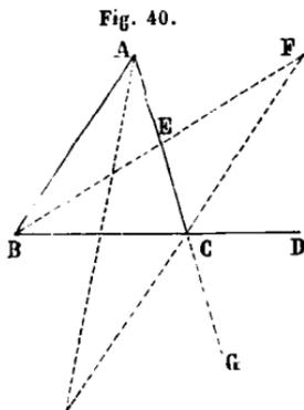
gnons B au milieu E de la droite AC, et faisons tourner le triangle EBA autour du point E, jusqu'à ce que EA vienne s'appliquer sur son prolongement EC, et par suite le point A sur le point C. L'autre côté EB de l'angle BEA viendra aussi s'appliquer sur son prolongement. La ligne BA partira donc du point C pour aller rencontrer BEF dans l'intérieur de l'angle ACD. Donc l'angle ECF ou BAE sera contenu dans l'angle ACD. Donc enfin l'angle A est moindre que son alterne-interne ACD.
