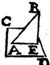
Angulus inclinationis, quo recta AB, inclinatur ad planum CD, est angulus BAE, quam BA, facit cum AE, ducta per punctum E, in quod cadit perpendicularis
