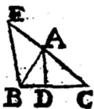
**S**it BE parallela AD, & occurrat CA in E. Ergo per 29. primi, anguli AEB, ABE sunt æquales æqualibus DAC, DAB: & ideo per 6. primi AB, AE sunt æquales. Ut autem AE ad AC, ita est per 2. BD ad DC. ergo etiam ut AB ad AC, ita est BD ad DC.
