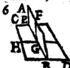
6 Plani A B, inclinati ad planum C D; inclinationis angulus est F G H, cum G F, G H, sunt perpendiculares ad B. D communem intersectionē E B.
