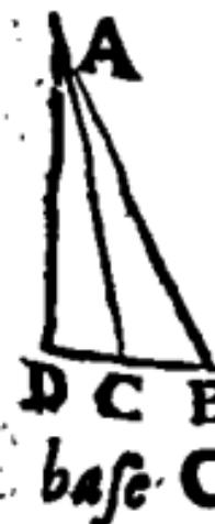
4. La hauteur de quelconque figure est la ligne perpendiculaire AD, menée du sommet sur base CB.
