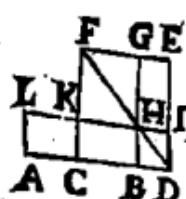
Si vne droite AB, est mi-partie en C. & qu'on luy adiouste directement quelque droite BD. le rectangle AI, compris sous la toute AB. avec l'adioustée BD. & sous l'adioustée DI. c'est BD. avec encores le quarté KG. de la moitié KH. o'est CB. est égal au quarté CE. de la ligne CD. composée de la moitié CB. & de l'adioustée BD.
