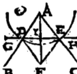
Sur une droite donnée infinie GH. d'un point donné hors d'icelle A. abaisser une droite AI. perpendiculaire.
