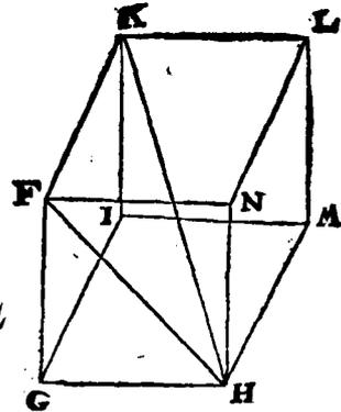
GL, en leuant les quatre lignes perpendiculaires GF, IK, ML, HN, par la 12. p. 11. qu'on fera égales à GH, & en menant les quatre lignes KF, FN, NL, LK.
