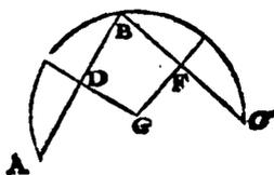
Soient pris trois points à l'aduanture en icelle section A, B, C, & apres auoir mené les deux lignes AB, & BC & icelles coupées en deux egallement, en D, & F d'iceux points soient leuées les perpendiculaires DG, & FG serencontrans au point G. Je dis que G est le centre cherche pour acheuer le cercle.
