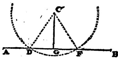
Car les deux triangles DCG, & FCG, ont deux costez egaux à deux costez: comme DC, & CG à FC & CG, & les deux angles sous le point C, egaux, & par la 4. p. 1. les bases DG & GF seront egales, & les autres angles egaux aux autres angles, chascun au sien: ainsi les deux angles au point G seront egaux, & par la definition de l'angle droit, ils seront droits, & la ligne perpendiculaire.
