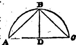
Qu'il ne soit ainsi, il faut mener les lignes AB, & BC & pour autant que les deux costez AD, & DB du triangle ADB sont egaux aux deux costez CD, & DB du triangle CDB, & les deux angles au point D egaux par la 4. p. 1. la base AB sera egalle à la base BC, & par la 28. p. 3. les circonferances AB, & BC seront egalles.
