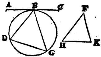
Car puis que la ligne BD coupe le cercle en deux, l'angle G en la grande section sera égal à l'angle de la touchement ABD, & par conséquent à l'angle H par la 32. p. 3 & par la mesme raison, la ligne BG coupant le cercle, l'angle D se trouuera aussi égal à l'angle K, & par la 32. p. 1. le troisieme B, sera aussi égal à l'angle F, & les triangles seront equiangles.
