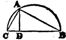
Car si on meine les deux lignes CA & AB, l'angle CAB, dans le demy cercle sera droit par la 31. p. 1. & le triangle CAB rectangle, & par la 8. p. 6. la perpendiculaire AD, le diuifera en deux triangles equiangles BDA, & ADC, & par la 4. p. 6. les costez qui sont au long des angles droits, seront proportionaux, sçauoir que comme BD à DA, ainsi DA à DC: par ainsi DA sera moyenné proportionnelle.
