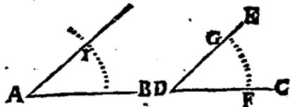
l'angle donné es points F, G; puis du même intervalle, soit décrit du centre A un arc interminé HI: En apres, soit prise la distance FG, & icelle portée sur l'arc HI, puis du point A par I, soit tirée la ligne droite AI, & sera fait l'angle HAI égal à l'angle donné CDE.
