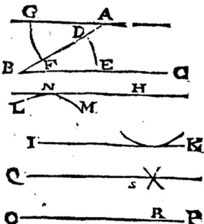
Encore autrement : Si du point  $Q$ , il faut tirer une ligne parallèle à une ligne donnée  $OP$ , soit pris en icelle ligne quelconque distance, comme  $OR$ , avec laquelle soit décrit du centre  $Q$  un arc  $S$ ; puis soit pris la distance ou intervalle  $QO$ , & d'iceluy soit aussi décrit du centre  $R$  un arc qui coupe le precedent en  $S$ , & d'icelle intersection soit tirée par le point donné  $Q$  la ligne droite  $QS$ , laquelle sera parallèle à  $OP$ , ainsi qu'il étoit requis.
